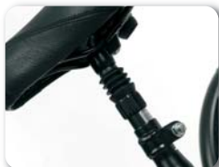
P5 - Tube de selle avec amortisseur
